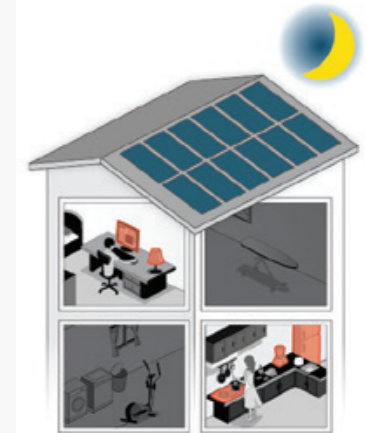
Nachts: Wichtige Verbraucher werden über die Batterie mit Strom versorgt.
