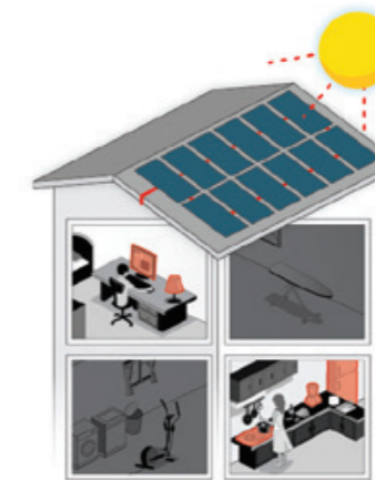
Tagsüber: Wichtige Verbraucher werden vorrangig über die Solarstromanlage, nachrangig über die Batterie mit Strom versorgt. Bei Bedarf kann die Batterie über die Solarstromanlage geladen werden.
